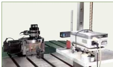
雷射角度定位量測系統
